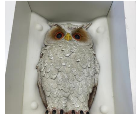
Fig. 7: de plasticine is verwijderd en de siliconen zijn bijgesneden. De eerste laag siliconen is voorzien van een losmiddel.
