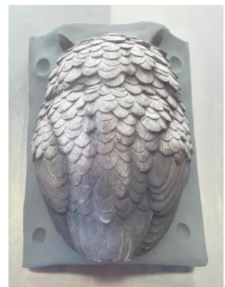
Fig. 3: Rondom de vorm (in de hoeken) zijn een aantal sleutels aangebracht.
