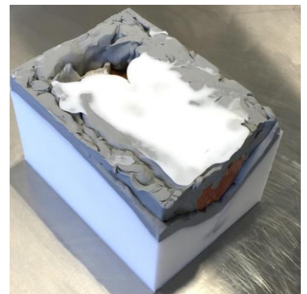
Fig. 6: Het model wordt inclusief plasticine en siliconen omgedraaid.
