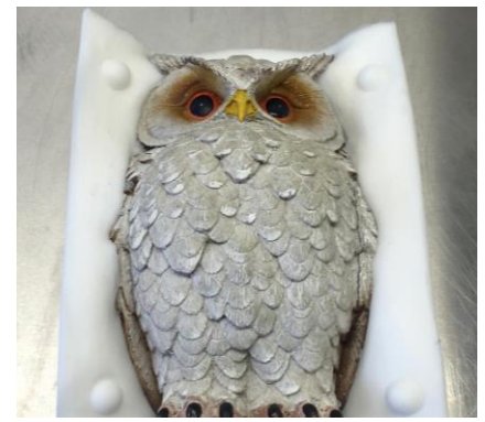
Fig. 7: de plasticine is verwijderd en de siliconen zijn bijgesneden. De eerste laag siliconen is voorzien van een losmiddel.
