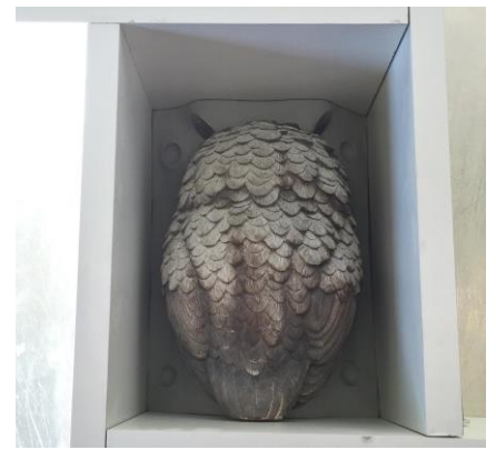
Fig. 4: Een ingebed model met aangebrachte omkisting. Gereed om gegoten te worden.
