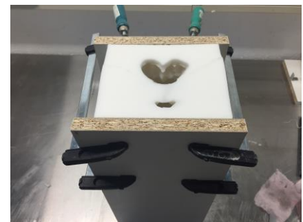
Fig. 9: De mal tussen twee plankjes voorzien van een aantal klemmen.
